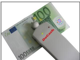
Подключив **DoCash M** к детектору **DoCash DVM BIG D**, Вы получаете возможность контролировать наличие и положение магнитных меток на исследуемой банкноте (документе) при помощи светового и звукового сигналов.
