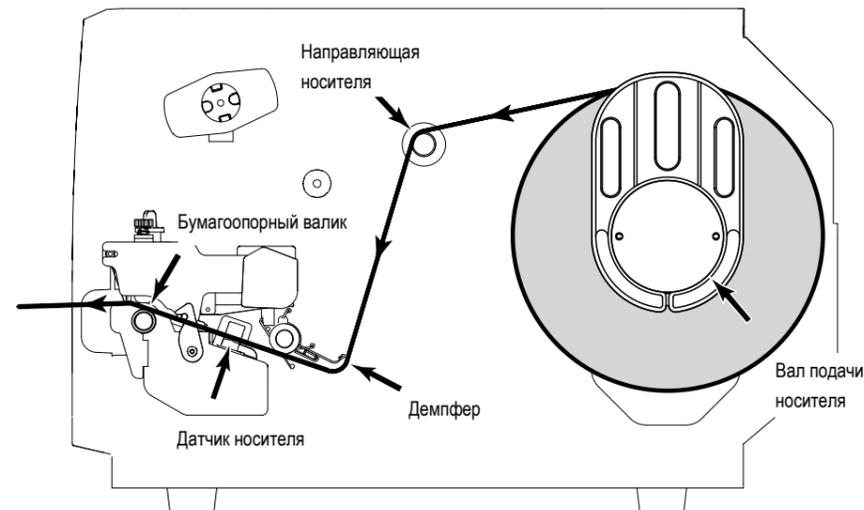
(7) Пользуясь дисплеем на лицевой панели, задайте тип датчика носителя и откалибруйте его. См. раздел «Калибровка датчика носителя» на следующей странице.
