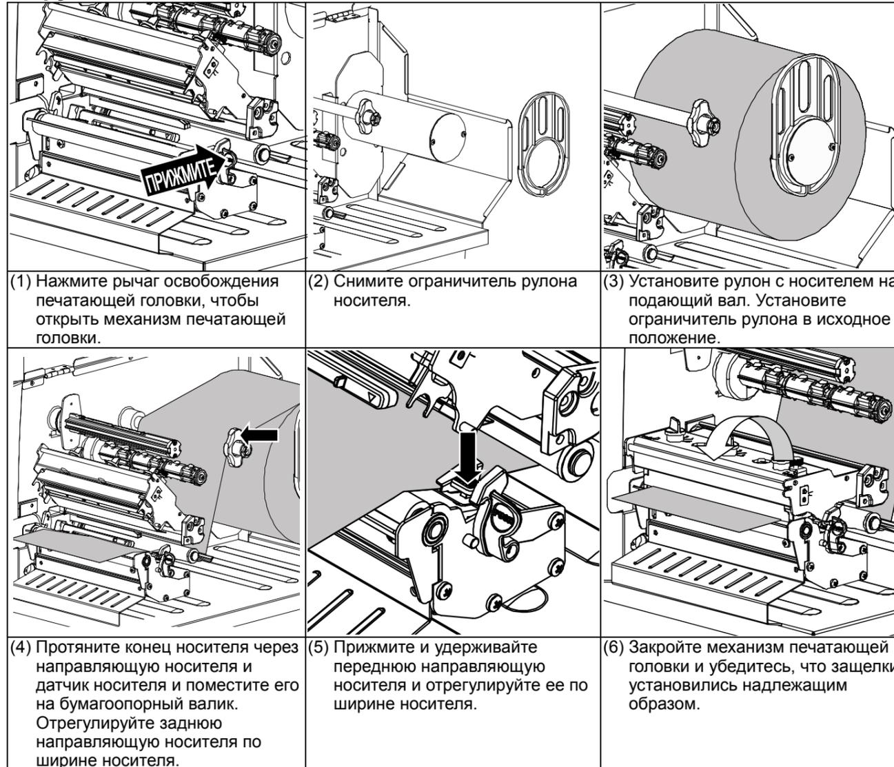
(1) Нажмите рычаг освобождения печатающей головки, чтобы открыть механизм печатающей головки.
