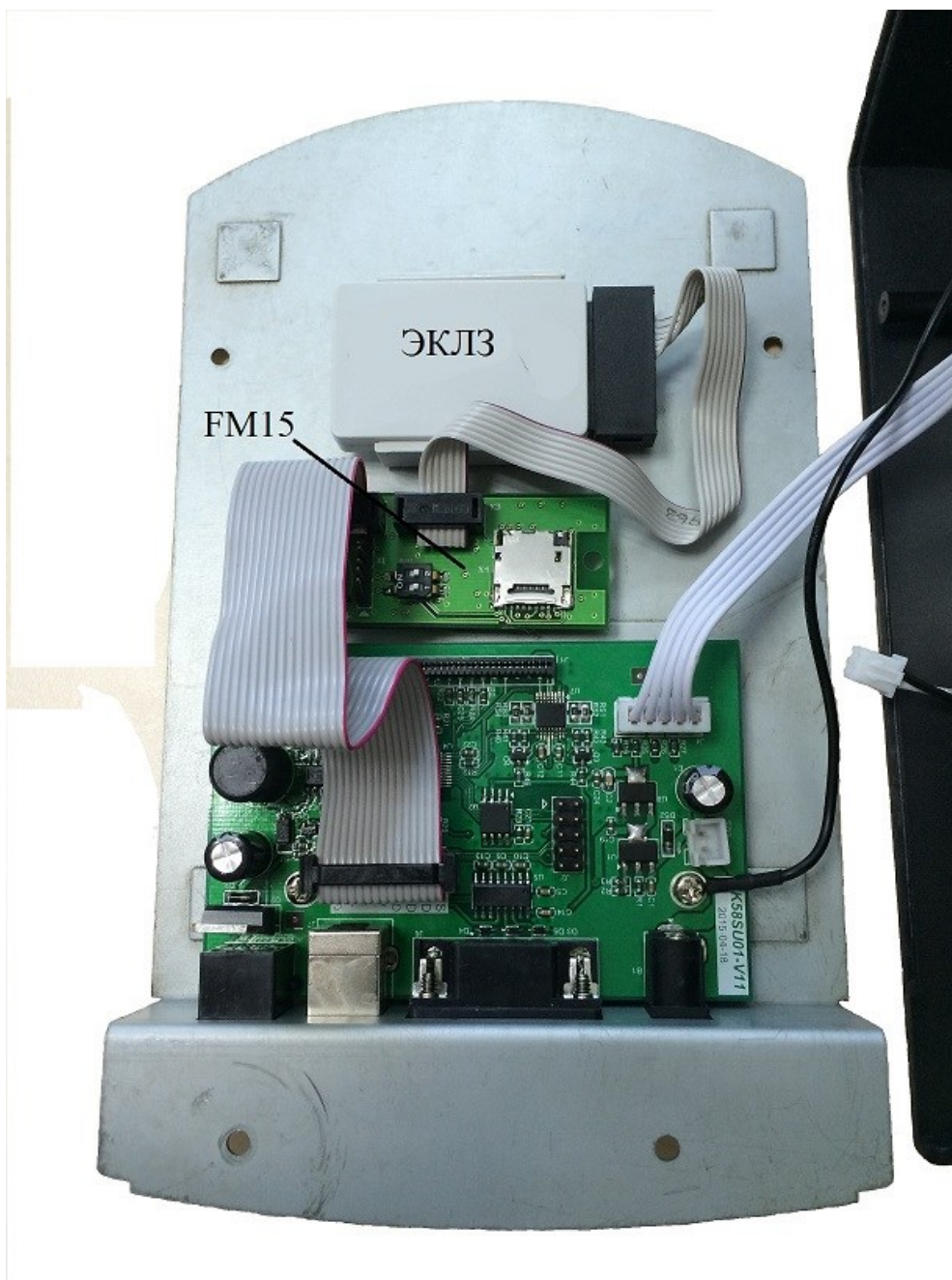
Рис.4 Вид ФП, ЭКЛЗ и системной платы ПМ в шасси
