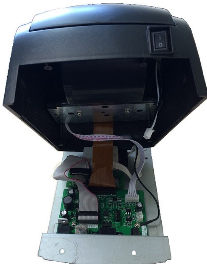
Рис.3 Вид основного блока ПТК со снятым шасси
