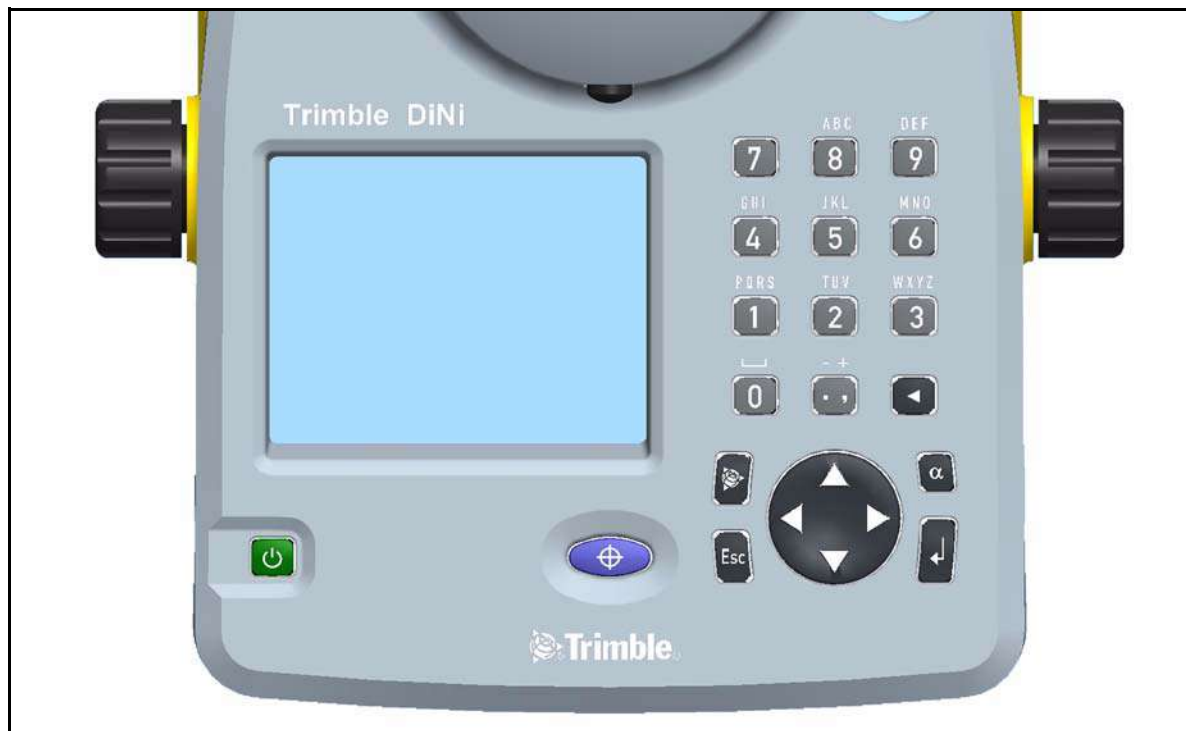
Рис. 3.2 Органы управления и дисплей нивелира DiNi®
