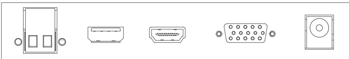
1.2.1 Двухконтактный клеммный блок PC\_SW – для удаленного включения ПК с помощью соответствующей кнопки в верхней части монитора.
