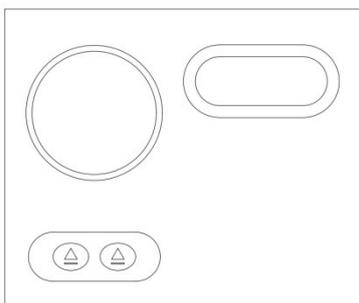
**1.6.1** В базовой комплектации лифт имеет только кнопки «вверх» и «вниз». Управление включением и отключением микрофона является опцией. Стандартным решением для лифтов данной серии является конгресс-система Bosch. Производитель гарантирует работоспособность данных систем с лифтами Wize. При использовании данных систем на лифт ставится
