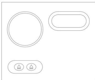
**1.4.2** В базовой комплектации лифт имеет только кнопки «вверх» и «вниз». Управление включением и отключением микрофона является опцией. Стандартным решением для лифтов данной серии является конгресс- система Bosch. Производитель гарантирует работоспособность данных систем с лифтами
