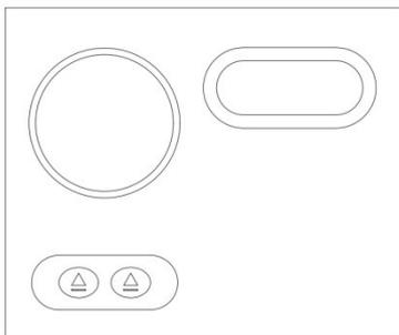
**2.3.1** В базовой комплектации лифт имеет только кнопки «вверх» и «вниз». Управление включением и отключением микрофона является опцией. Стандартным решением для лифтов данной серии является конгресс-система Bosch. Производитель гарантирует работоспособность данных систем с лифтами
