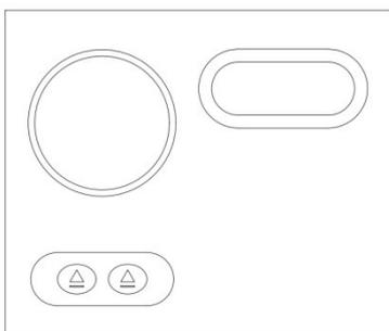
**1.4.2** В базовой комплектации лифт имеет только кнопки «вверх» и «вниз». Управление включением и отключением микрофона является опцией. Стандартным решением для лифтов данной серии является конгресс-система Bosch. Производитель гарантирует работоспособность данных систем с лифтами Wize. При использовании данных систем на лифт ставится
