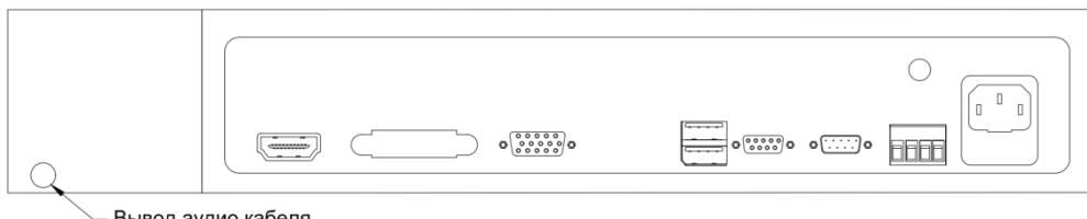
**1.3.1** На схеме изображена задняя панель вывода кабеля с микрофонного лифта с учетом использования конгресс-систем Bosch.
